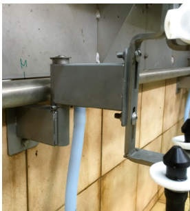
Adapter für diverse Melkzeuge und Abnahmeseil
