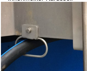
Führung für Schlauch im Innenmelker-Karussell
